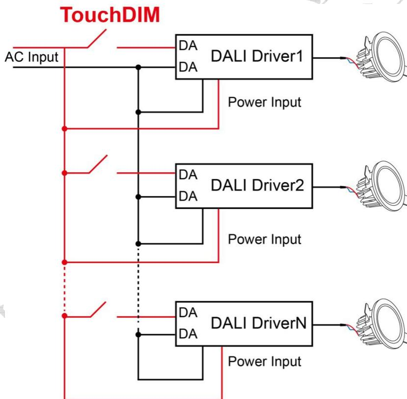
备注：只能使用开路的按压式开关（不带指示灯）。采用同步连线时每个设备和设备之间的线长不超过 20 米。
